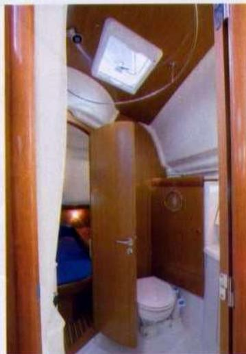
scarichi: elettrici con interruttore - Ventilazione: un osteriggio - Illuminazione naturale: buona - Illuminazione artificiale: alogena e luce nel mobile - Rumorosità motore in navigazione: 69 dBA.
